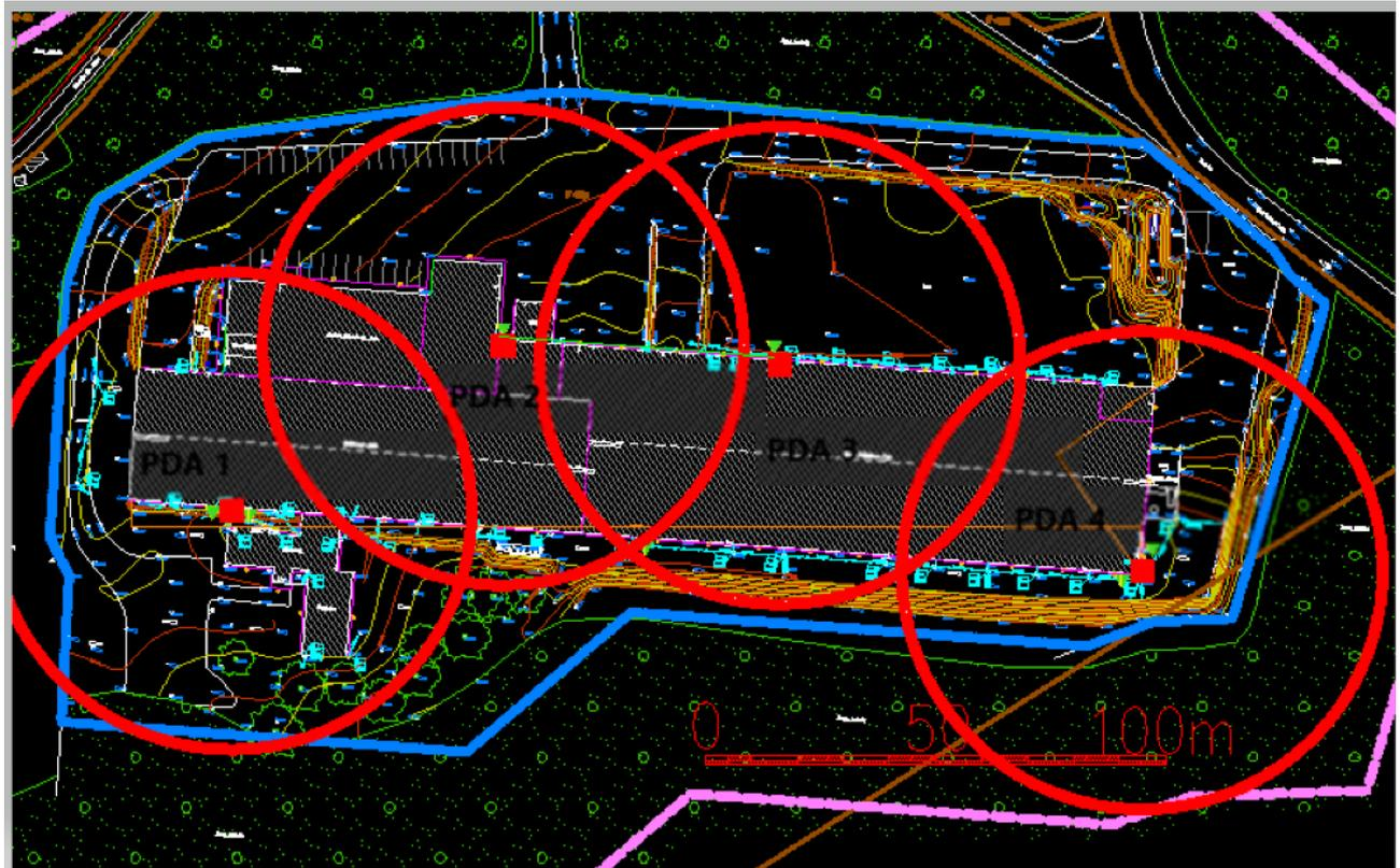
**Figure 9 : Implantation des paratonnerres**
